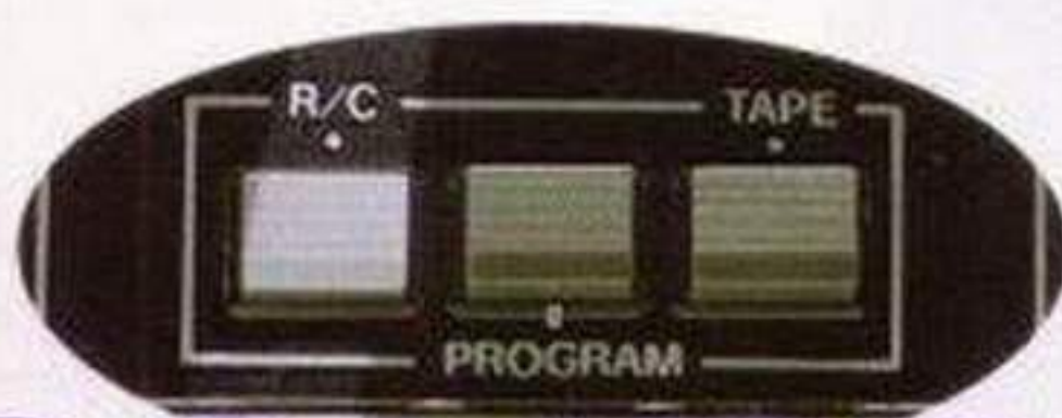
ラジオコントロールモードはオムニボット本体のモード切り換えボタンを、R/Cにセット。
